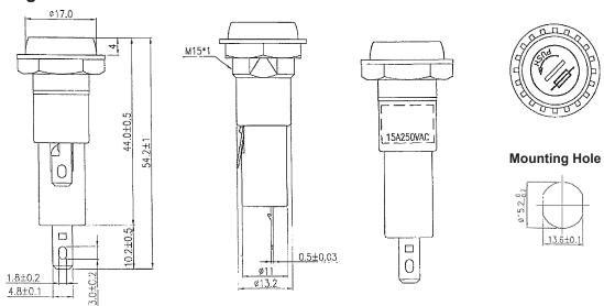
Dimensions : Millimetres Tolerances : ±0.3mm
